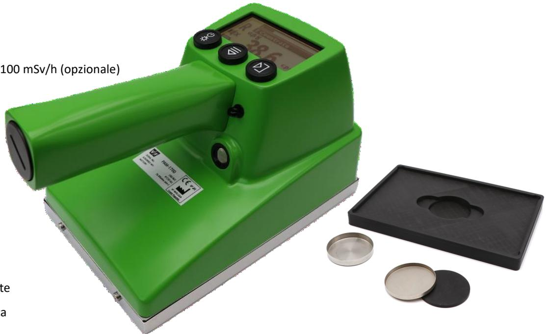
Gli strumenti portatili della serie PAM-170 (Portable Activity Meter - 170 cm<sup>2</sup>) nascono per la misura della contaminazione superficiale. Il rivelatore interno a scintillazione è coperto dalla finestra leggera, protetta da apposita griglia, e accoppiato a un fotomoltiplicatore e a un'elettronica di processo a due canali. I modelli A, B e C hanno una sensibilità limitata alla radiazione gamma. Ciò permette di impostare soglie di allarme più basse rispetto ai modelli D ed E.
